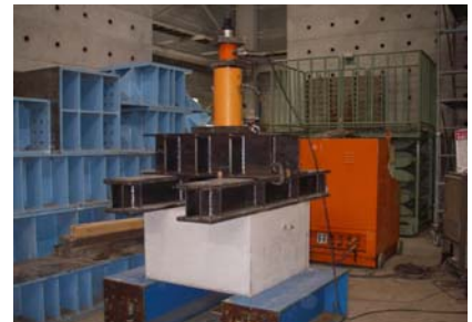
写真-6 引抜実験状況
