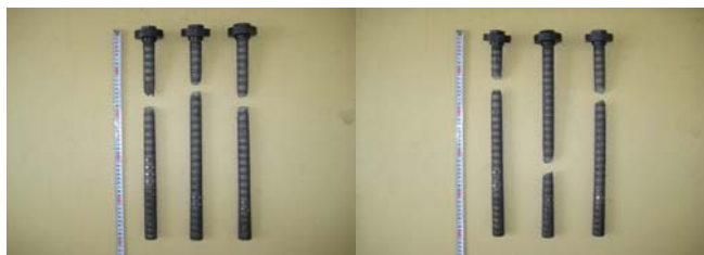
写真-4 定着具の引張試験結果 D25 SD345(竹節)
