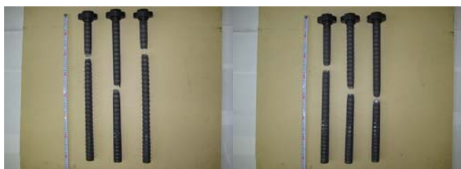
写真-5 定着具の引張試験結果 D35 SD345(竹節)
