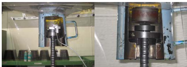
写真-2 定着具の引張試験状況
