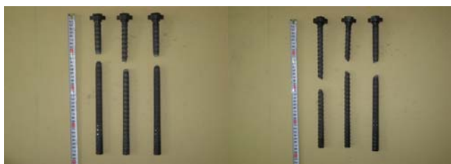
写真-3 定着具の引張試験結果 D16 SD345(竹節)
