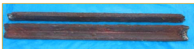
写真-2 鋼材の腐食状況（9年後）
