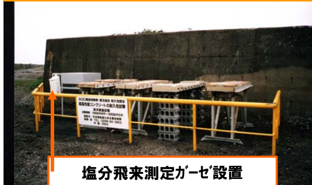
写真-1 海洋曝露状況
