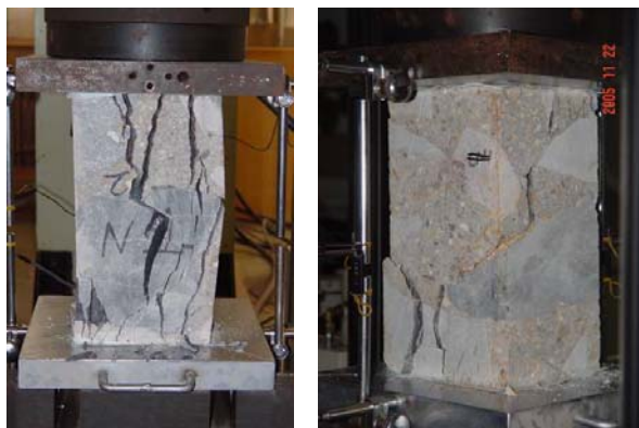
図-13 供試体破壊状況
