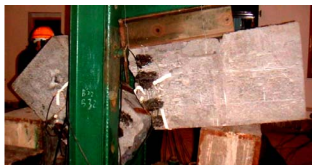
図-8 試験 1 試験体の曲げ試験状況
