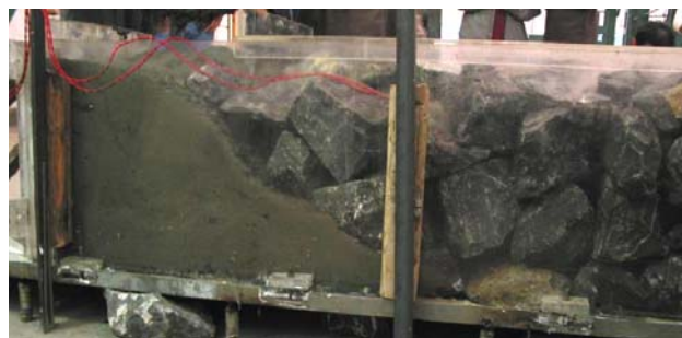
図-6 SCCの流動状況
