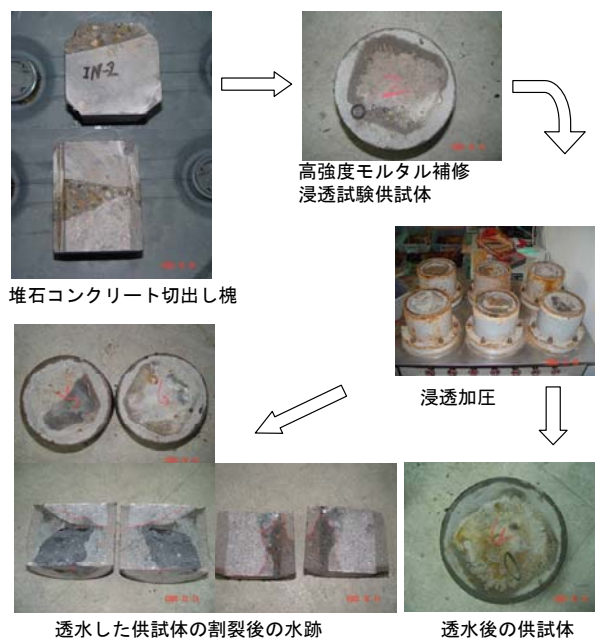
図-14 堆石コンクリート切出し供試体浸透試験
