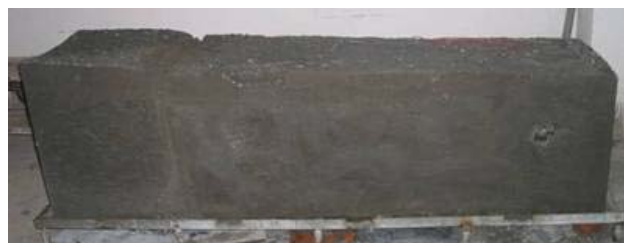
図-7 試験後の堆石コンクリート (試験 1)
