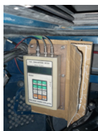
写真-6 燃費計設置状況
