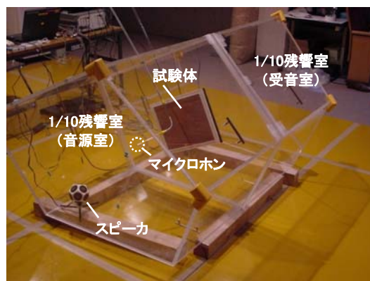
写真-1 音響透過損失の実験状況
