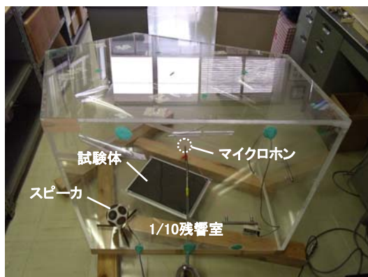
写真-2 吸音率の実験状況
