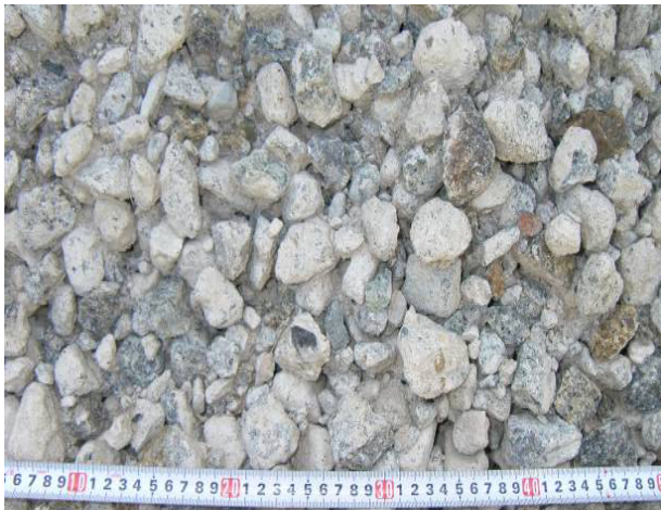
写真-5 製造された再生粗骨材（5～40mm）
