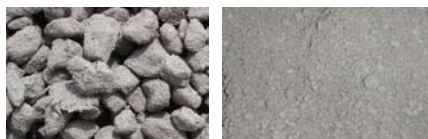
写真-2 再生骨材(左:粗骨材,右:細骨材)
