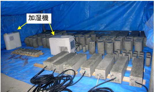
写真-1 湿度 95%制御の養生装置
