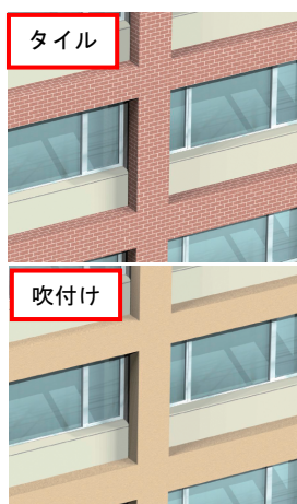
図-2 補強フレームの仕上げイメージ
