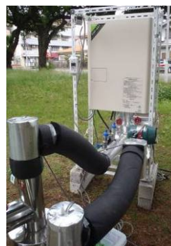
写真-1 熱応答試験装置
