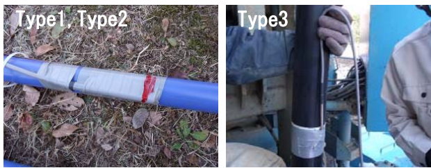
写真-2 温度センサの設置状況
