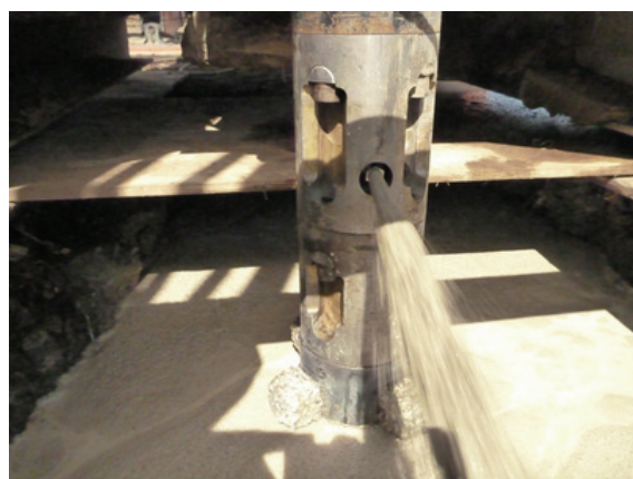
図-23 噴射テスト状況（噴射状況）
