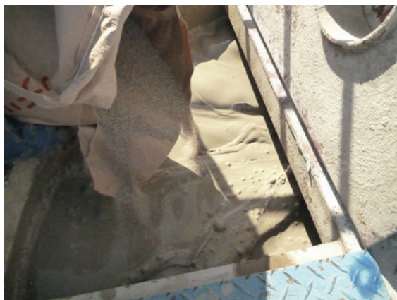
図-22 噴射テスト状況（珪砂混合状況）
