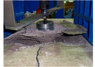
S-12 破壊状況
