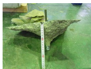
T-10 破壊状況
