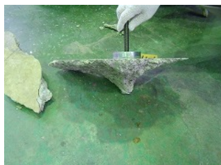
T-11 破壊状況
