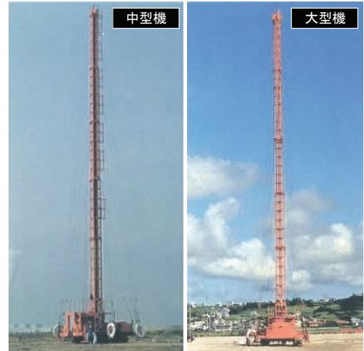
写真-3 PBD 打設機
