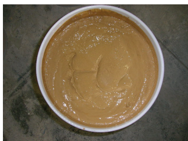
写真-1 地下連続壁施工時排泥
