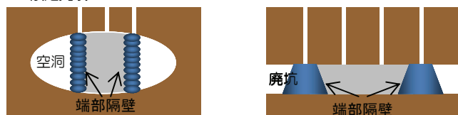
図-1 空洞充填工法
