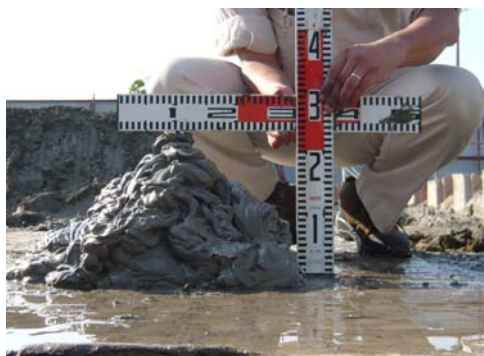
写真-1 端部隔壁工試験打設結果
