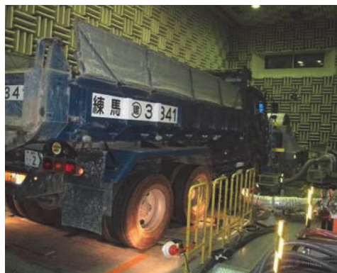
写真-4 D13 モード試験状況
