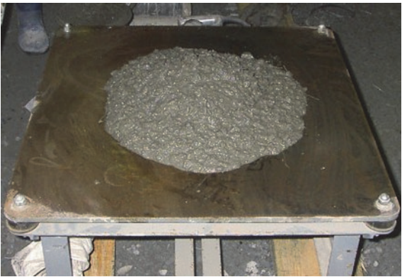
写真-1 加振前のスランプフロー性状
