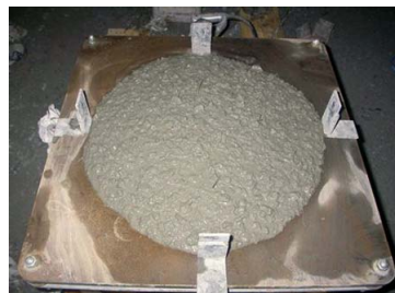
写真-2 加振後のスランプ性状
