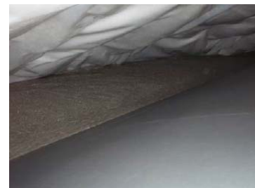
写真-3 中流動コンクリートの流動状況
