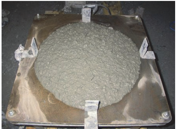
写真-2 加振後のスランプフロー性状
