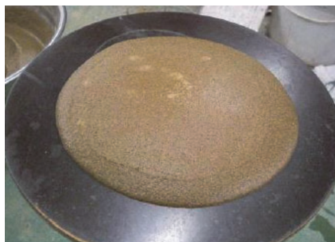
写真-2 気泡混合土のテーブルフロー試験状況
