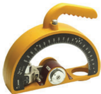
写真-4 低強度用シュミットハンマー
