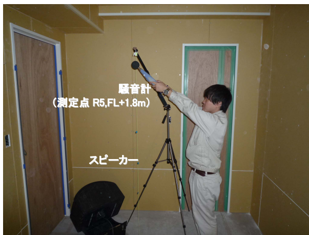
写真-4 遮音性能の測定(210 号室 洋室 2)
