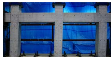
写真-5 最終破壊状況 (No.1 試験体)
