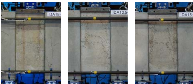
DA18-N 試験体 DA13.5-N 試験体 DA15-L 試験体 写真-9 実験終了時の破壊状況
