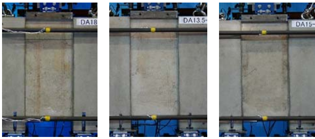
DA18-N 試験体 DA13.5-N 試験体 DA15-L 試験体 写真-8 打継ぎ部ずれ量 2mm 時の破壊状況
