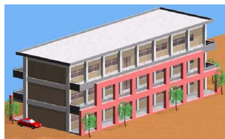
図-3 増設工法による補強イメージ
