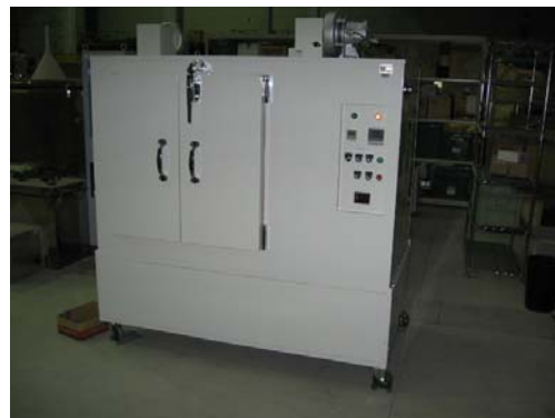
写真-1 乾燥炉の外観
