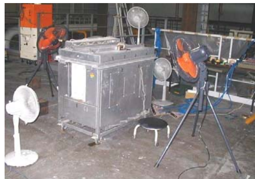
写真-2 電気炉の外観
