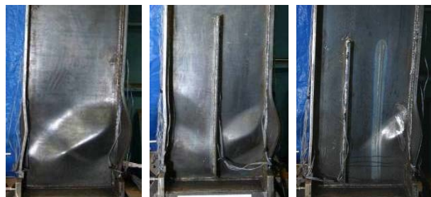
B11 (無補剛) B12 (1 枚補剛) B13 (2 枚補剛) 写真-1 破壊状況 ( -4\delta_p サイクルピーク時)
