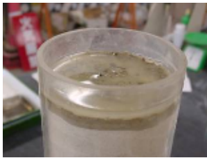
(a) 絶乾状態の混合土に 上面から加水
