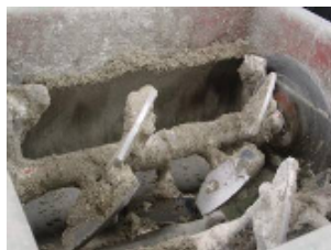
(c) 攪拌翼、攪拌軸、胴部 (d) 発生した不均質部（ダマ）の状況
