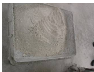
(a) 自然含水状態でのベントナイトと砂の混合状況
