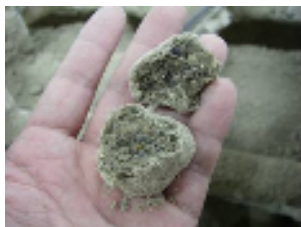
(c) 攪拌翼、攪拌軸、胴部 (d) 発生した不均質部（ダマ）の状況
