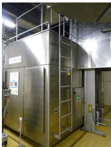
写真-3 実証試験にて使用した生ごみ溶解槽 (1t/日規模)
