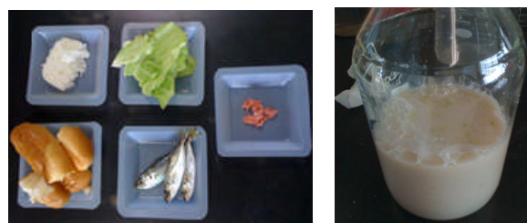
写真-4 模擬生ごみ (左：原料，右：混合・攪拌後)
