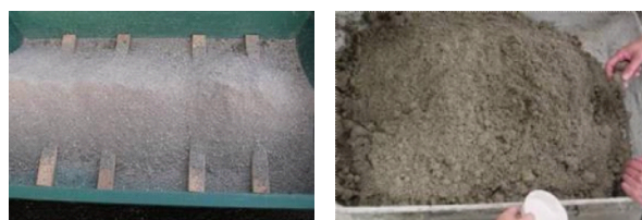
(1) ミストブレンダー製造土 (2) 強制二軸ミキサー製造土 写真-1 ベントナイト混合土の比較
