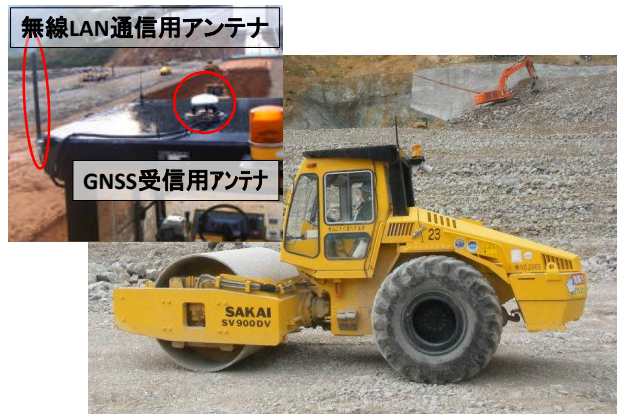
図-6 締固め管理システムの構成
