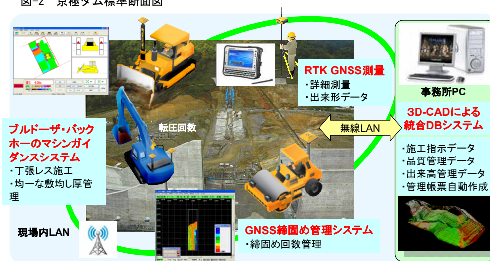
図-1 ICT 土工管理システムの概念図
