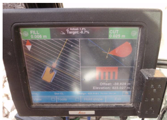
図-13 バックホウ MG の指示画面
