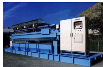
写真-9 真空加圧脱水機(3m³タイプ)
