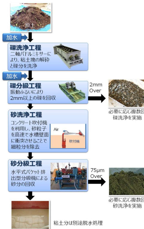
図-5 土壌洗浄設備の概要
