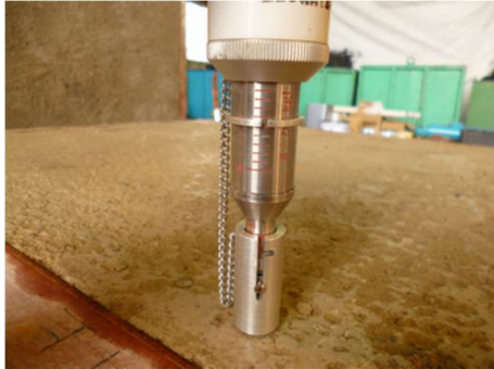
写真-3 針貫入試験による強度確認
