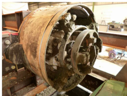
写真-6 内カッター前出し(100mm)
