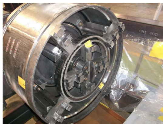
写真-1 二重回転カッター実験機 (内外比=1:2)
