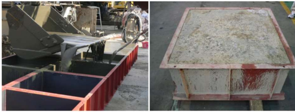
写真-2 供試体(模擬地盤)の作製(左)～完成(右)
