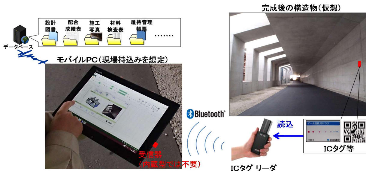
図-6 IC タグを活用した実構造物と CIM モデルの連携イメージ
