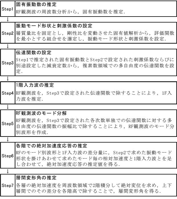
図-1 RF 観測波から各階の応答を推定する手法
