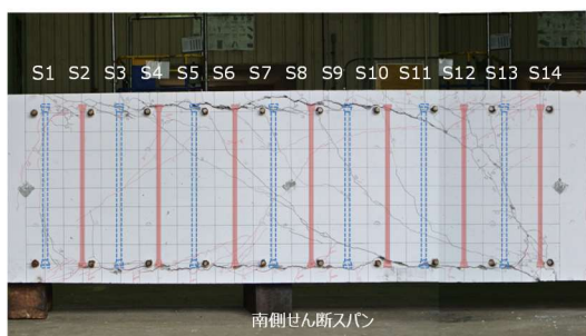
図-10 終局せん断耐力時におけるせん断補強鉄筋のひずみ分布 (CASE6/T29)
