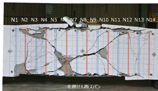
図-10 終局せん断耐力時におけるせん断補強鉄筋のひずみ分布 (CASE6/T29)
