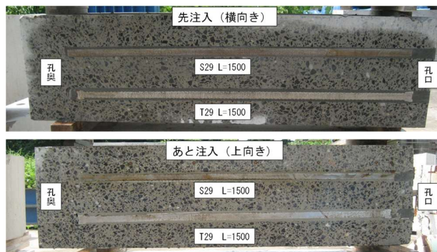
写真-5 切断した試験体
