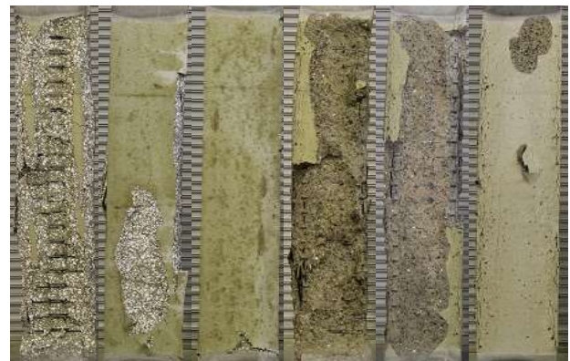
写真-3 載荷加熱実験終了後の試験体状況
