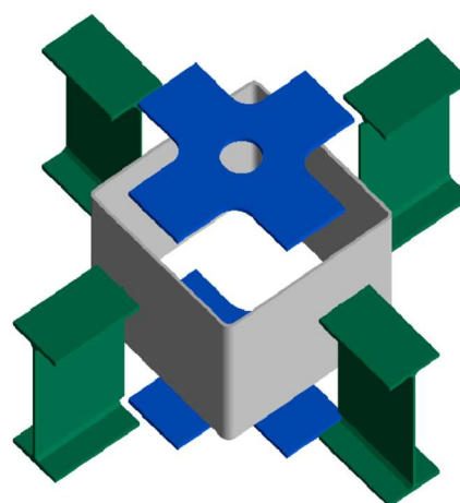
図-3 MaRCSⅢ構法の鉄骨組立て
