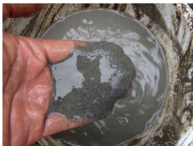
写真-10 磁選機により回収した特殊鉄粉
