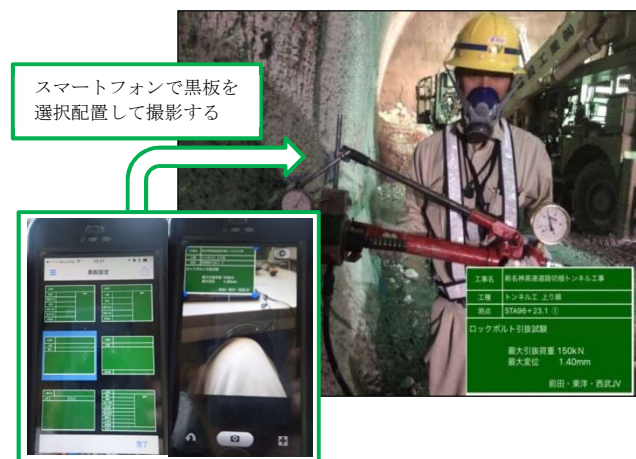
図-4-9 立会検査業務フロー図（ICT化
