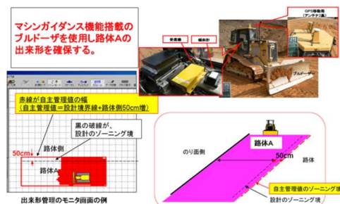
図-3-2 ブルドーザ巻出し管理
