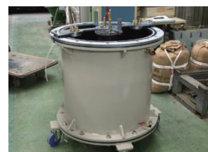
写真-2 模擬ケーソン円形土槽実験装置
