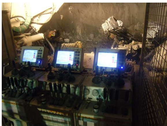
写真-9 大船渡側工区ドリルジャンボ（トンネルナビゲーションシステム搭載型）
