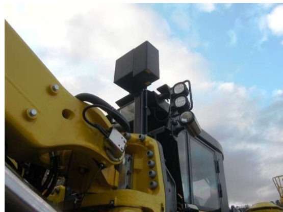
写真-11 3D スキャナー搭載型ドリルジャンボ（全自動フルコンピュータジャンボ）
