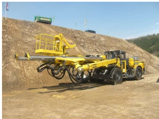
写真-11 3D スキャナー搭載型ドリルジャンボ（全自動フルコンピュータジャンボ）
