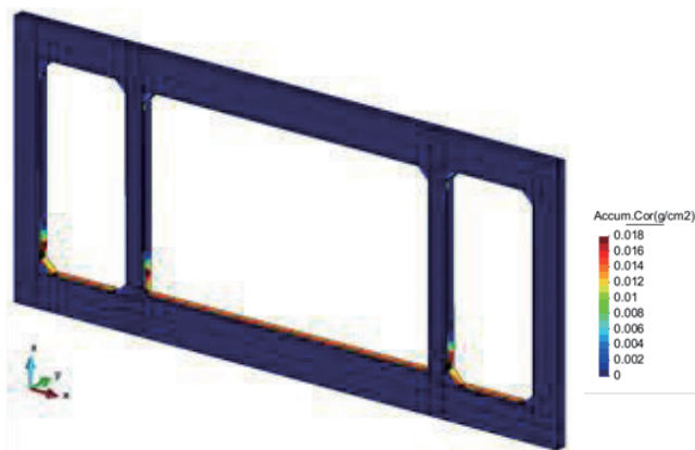
図-2 材齢 30 年の腐食量分布
