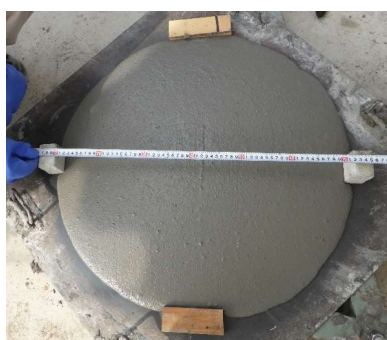
写真-1 スランプフロー試験状況
