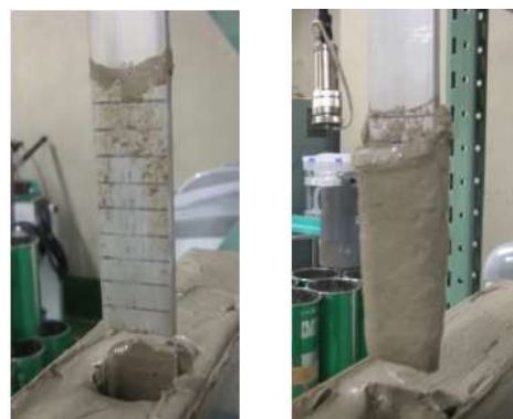
写真-5 引抜き実験後のマイナス電極の状況
