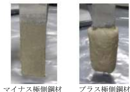
写真-2 通電後の付着状況 (含水比 40% t=10 分)
