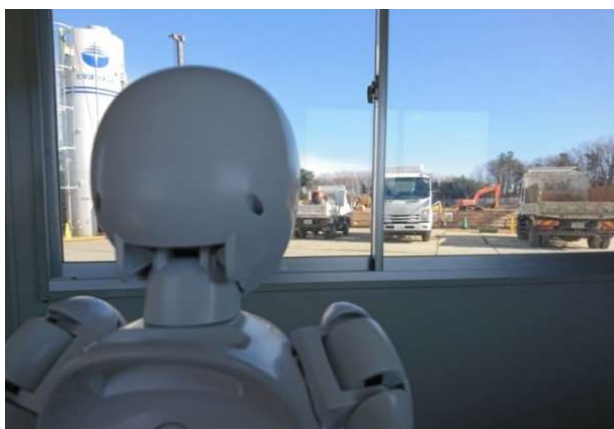
写真-5 OriHime による現場状況の確認
