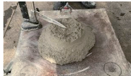
写真-1 低炭素型のコンクリートのスランプ試験
