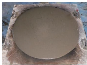
写真-1 ジオポリマー施工状況（左から、スランプフロー状況、打込み状況、押さえ状況、打込み完了状況）
