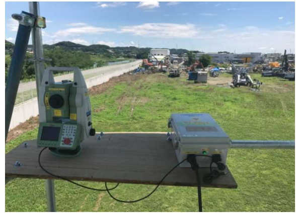
写真-11 自動追尾測量機設置状況
