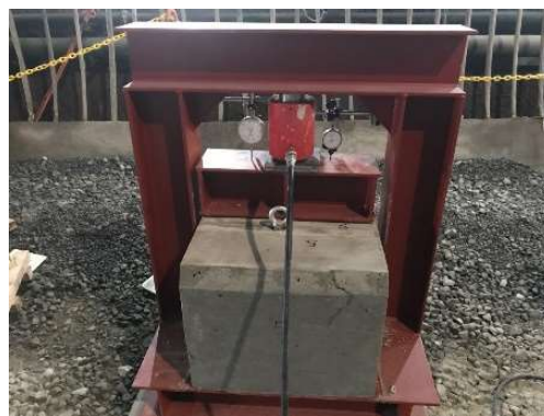
写真-6 緩衝ゴムの載荷試験の状況
