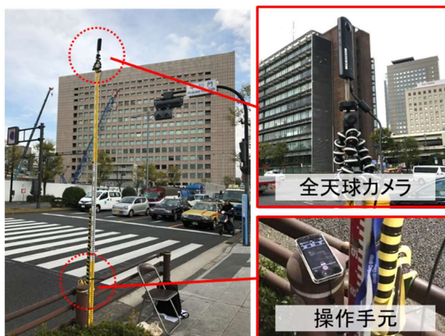
図-4(a) 交通量測定用の動画取得状況
