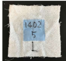
図-5 試験体（布片） （ポケット付き）
