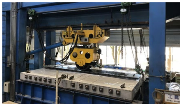
写真-8 輪荷重走行試験の状況
