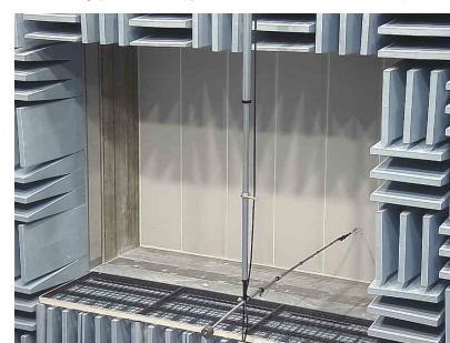
無響室側（トラバース装置）
