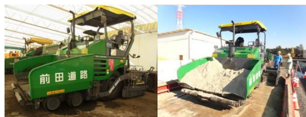
写真-2 アスファルトフィニッシャー概観
