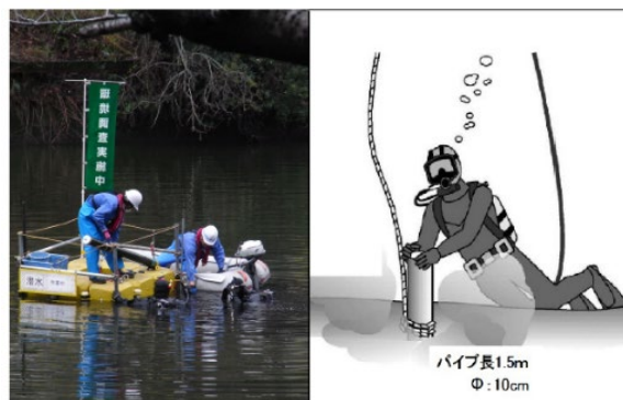
図-5 潜水作業による採泥状況(第2回採泥)
