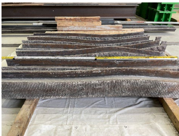
写真-1 主鋼材の基部より上の変形状況
