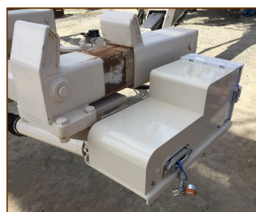
写真-7 ミラー自動回収機構
