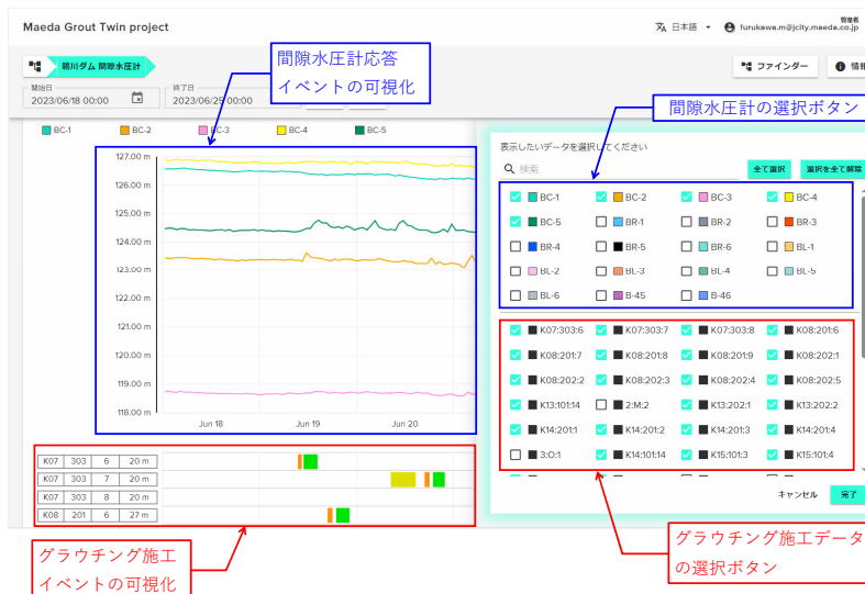
図-17 「Grout Twin」の操作画面
