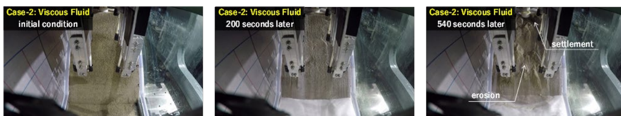
写真-6 GoPro による盛土法面画像 (Case-2)
