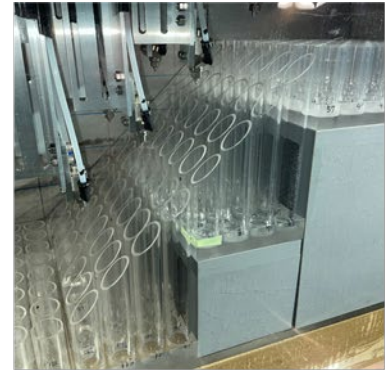
写真-3 アクリル円筒を並べたキャリブレーション用模型地盤
