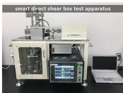
写真-7 スマート一面せん断試験
