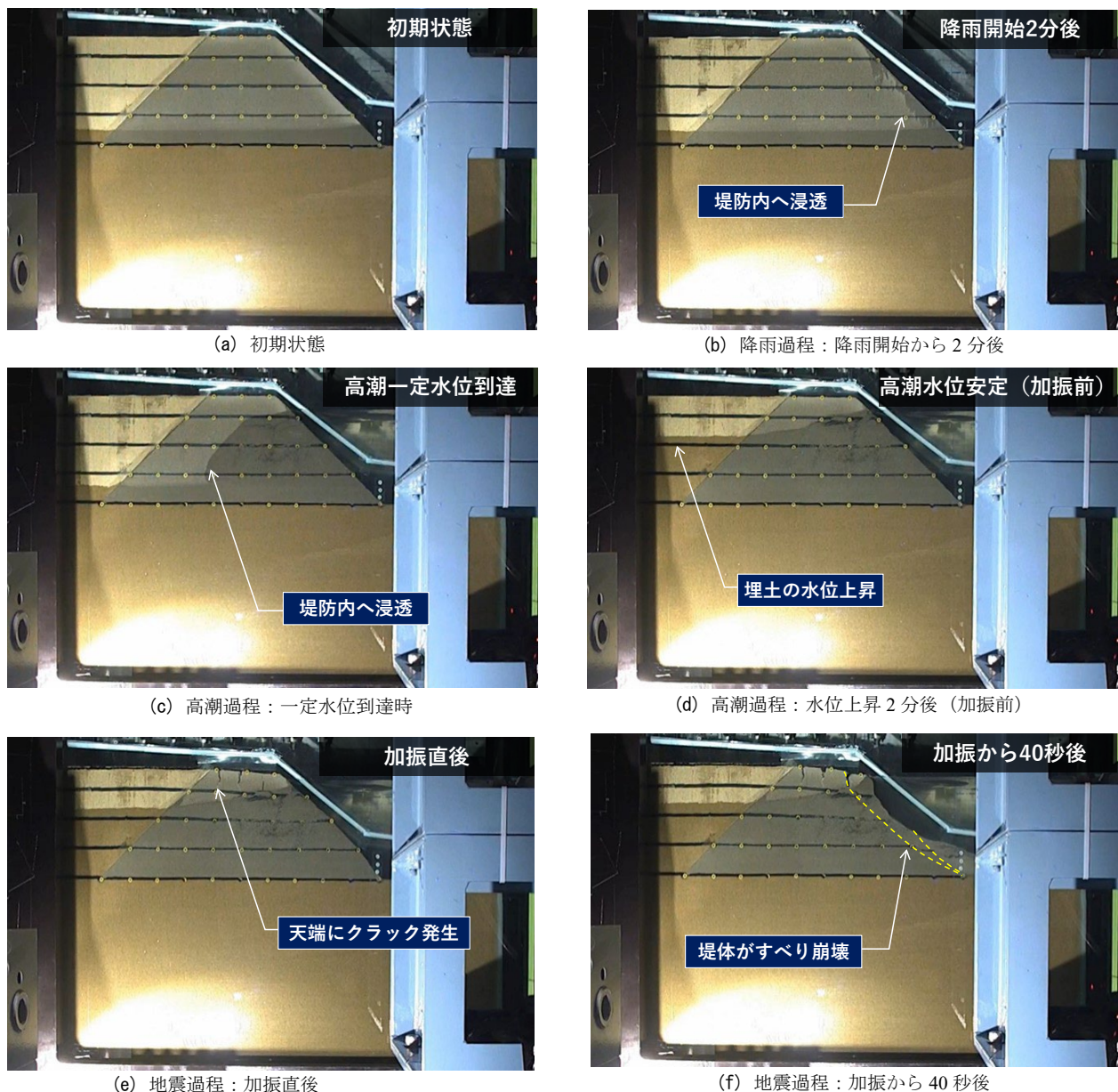
写真-3 CCD カメラで撮影した模型地盤の経時変化画像
